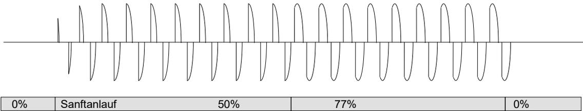
Abbildung 8 - Darstellung des Phasenanschnitts mit Sollwerttrampe bei Kaltstart
