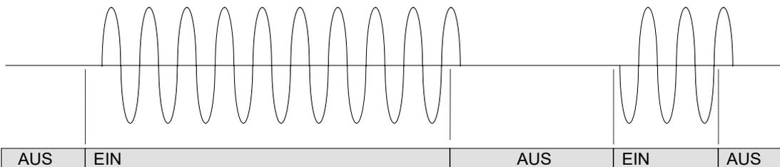
Abbildung 10 - Darstellung der Lastspannung bei Nullpunktschalter mit Überwachung
