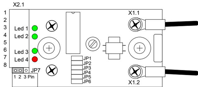
Abbildung 4 - Lage der Stecker, Jumper und LEDs
