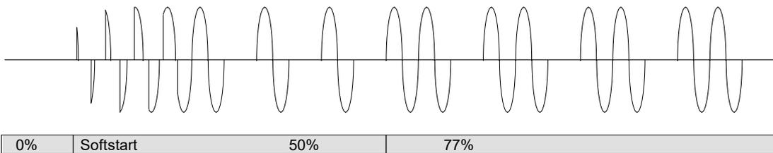
Abbildung 9 - Darstellung der Pulspaketsteuerung mit Sanftanlauf
