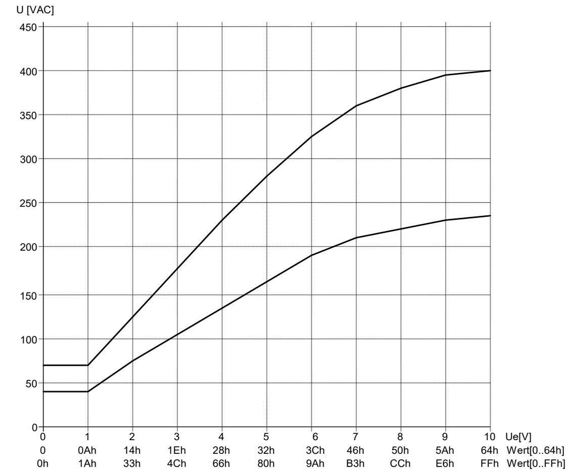
Abbildung 11 - Effektive Lastspannung via Steuerspannung
