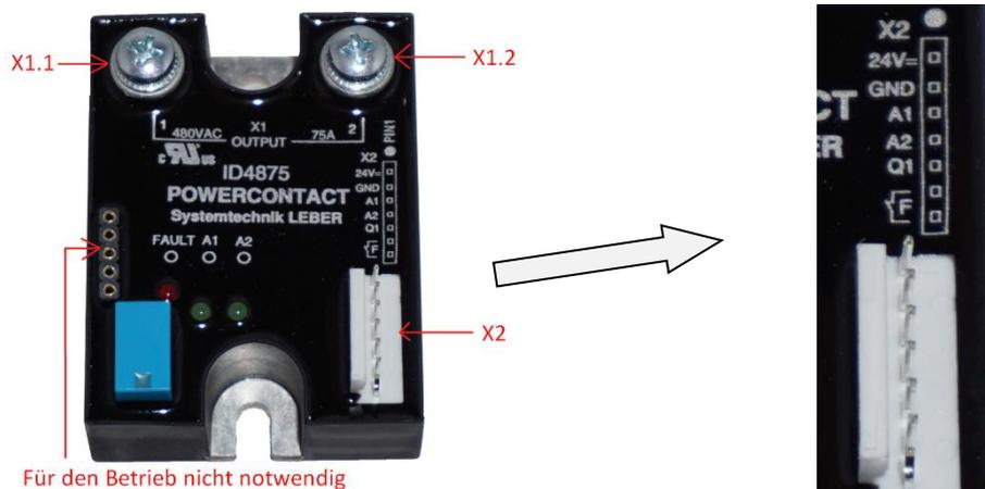
Abbildung 3: Belegung Stecker X1.1, X1.2 und X2
