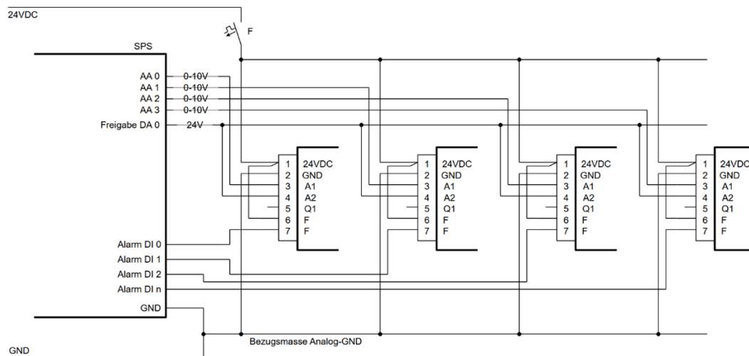
**Abbildung 13: Ausführung mit Einzelalarm-Auswertung**
