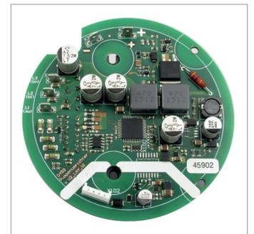
des sensorlosen BLDC-Motors wurde durch eine intelligente Sinuskommutierung erreicht.
